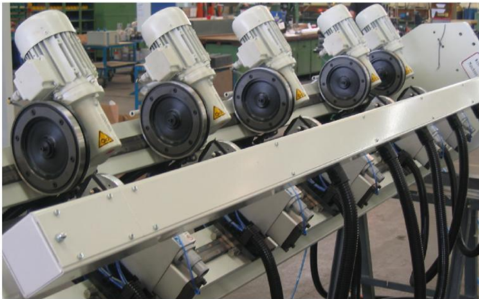
Zichtbaar zijn de ondermessen met motor en de bovenmeshouders
